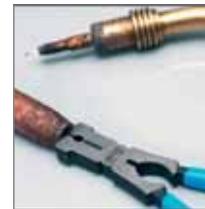
curatirea stropilor de sudura de pe duza de capat
