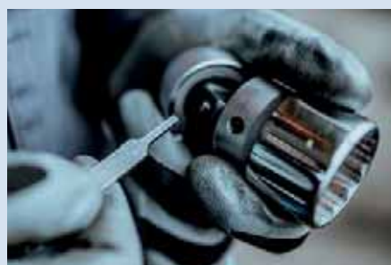
Când montați capete sau extensii, asigurați-vă că orificiul din priză și știftul de pe unitatea pătrată sunt aliniate. Utilizarea dispozitivului de îndepărtare a capetelor tubulare (articolul 1111) apasă știftul în timp ce atașează tubulara. Asigurați-vă că știftul face clic în gaură.
