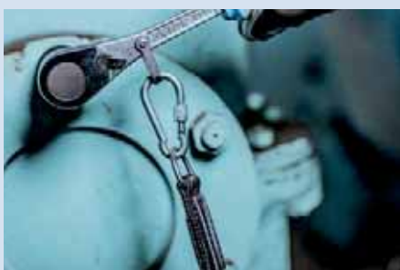
Utilizarea clicheului. Clicheul nu are buton pentru comutarea capetelor tubulare ca un cliche standard.
