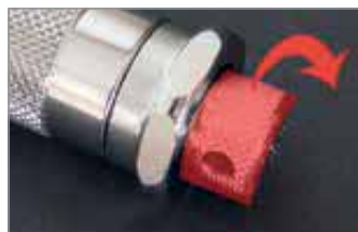
1. Desurubati surubul de la baza ca sa eliberati surubul pentru ajustarea cuplului de strangere
