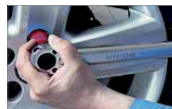
4. Ajustati si incepeti strangerea ( in sensul cuplului prestabilit). Cand auziti semnalul audio (click), cuplul prestabilit a fost atins. Opriti strangerea.
