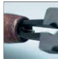
eliminarea stropii de sudura din interiorul si exteriorul duzei
