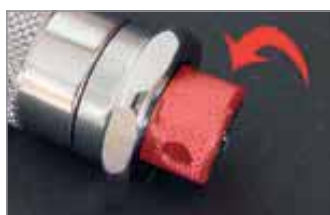
3. Insurubati la loc surubul de la baza pentru a fixa ajustarea cuplului.
